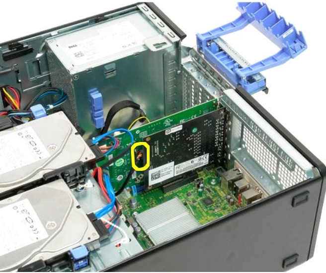
7. Til de uitbreidingskaart recht omhoog en verwijder deze uit de computer.
